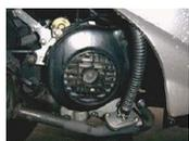
Откручиваем 2 гайки (M8) и два шурупа и снимаем облицовку:
