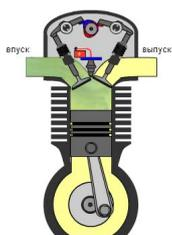
Второй такт, сжатие. Поршень идет вверх, топливная смесь сжимается. Когда поршень находится в нескольких миллиметрах от верхней мертвой точки (ВМТ), свеча воспламеняет топливо, сжатое поршнем.
