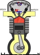
В процессе работы двигателя происходит следующее: в цилиндр поступает свежий воздух, который смешивается с топливом. Затем смесь сжимается, и происходит воспламенение. В результате этого процесса газы расширяются и выталкивают поршень вниз.
