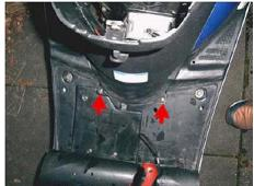
Далее осторожно снимаем сиденье вместе с ящиком для шлема (багажным отделением). Под ним находится двигатель. Теперь мотор свободен и нам ничего не мешает.
