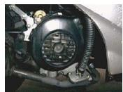
Откручиваем 2 гайки (M8) и два шрупса и снимаем облицовку:
